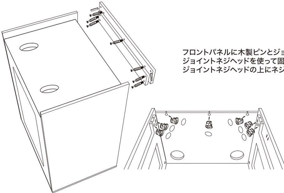
フロントパネルに木製ピンとジョイントネジを取り付け、ジョイントネジヘッドを使って固定します。ジョイントネジヘッドの上にネジ用シールを貼ります。
