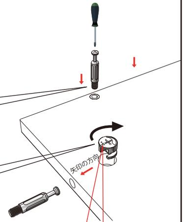
注意：矢印<の方向をジョイントネジの向きに合わせてナット穴に入れる
