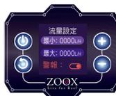
設定画面の流量設定を⏻を押して選択します。
