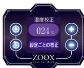
水槽システム内に他の水温計を設定している場合、配置場所によって表示される温度が異なる場合があります。
